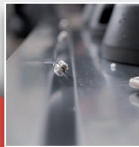
Ugello spruzzatore saldato sul piano
